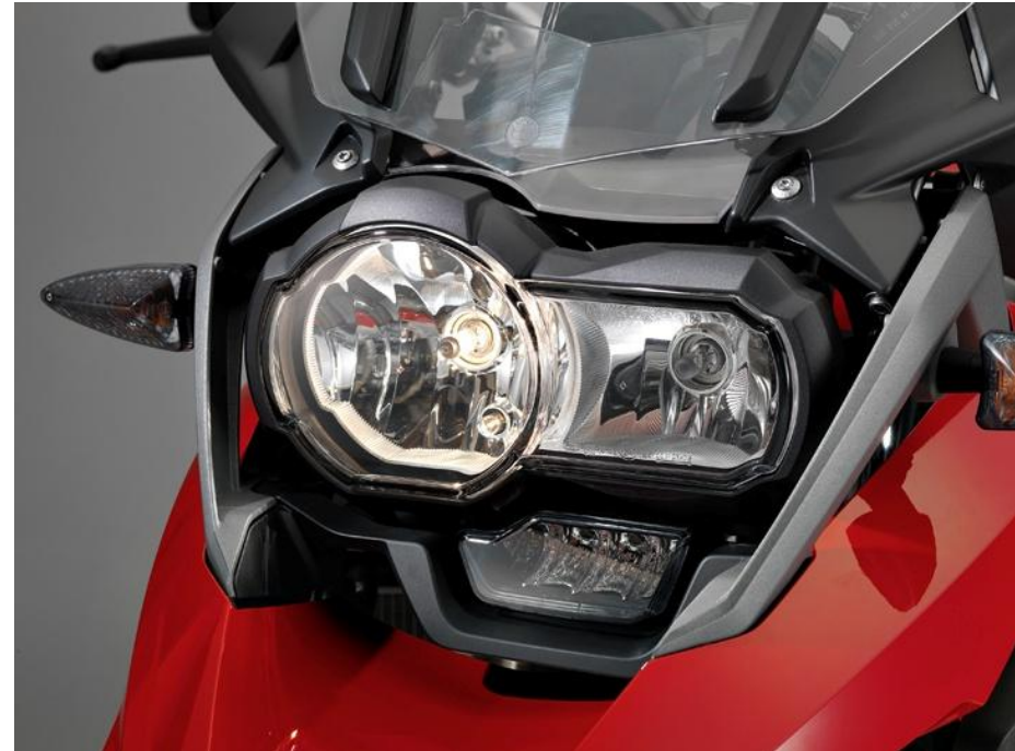
Serienscheinwerfer mit LED Tagfahrlichtmodul
