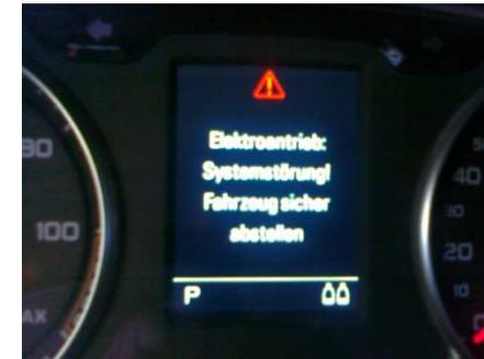
**Der Onboard Isolationswächter überwacht ständig (zyklisch) den Isolationszustand zwischen Karosserie (Bauteilgehäusen) und den HV - Terminals**
