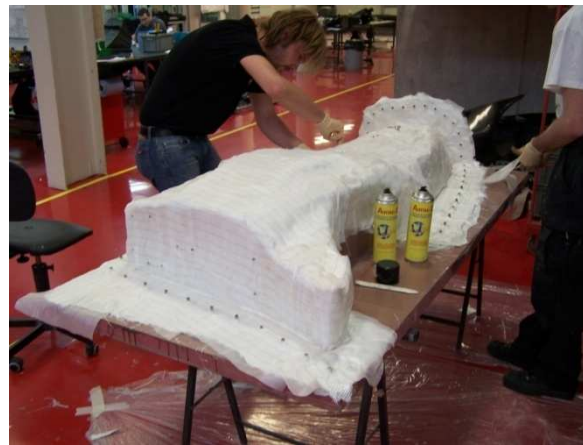
Negativform aus Glasfaser laminieren
